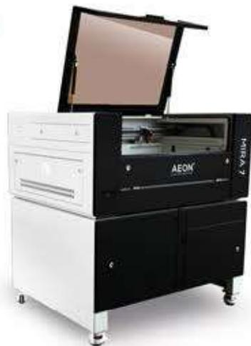
Notre dernier modèle professionnel MIRA 7 Va encore plus loin avec la sécurité Interlocked démarrage à clé, transformant ainsi la MIRA 7 en un laser de Classe 1 niveau optimum de sécurité. Le nouveau design conserve les meilleures caractéristiques de la génération précédente, telles que "clean pack Design" et les vitesses élevées, tout en ajoutant quelques touches de finition, comme le capot en verre trempé résistant au feu, des vérins à gaz, et des joints de fermeture en caoutchouc.
